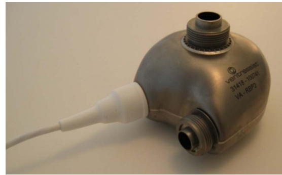
Fig. 15. A centrifugal pump (VentrAssist LVAD).
